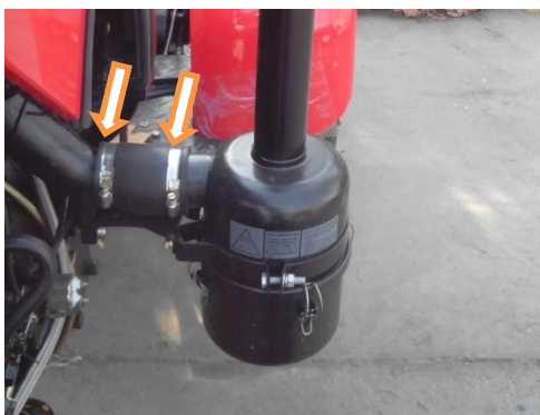
Зажим воздушного фильтра в масляной ванне
